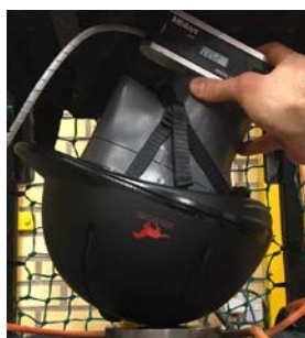
Figur 4. Hjälmprovingsrigg på RISE som används för det raka islaget. Huvudets initiala vinkel var 26 grader.
