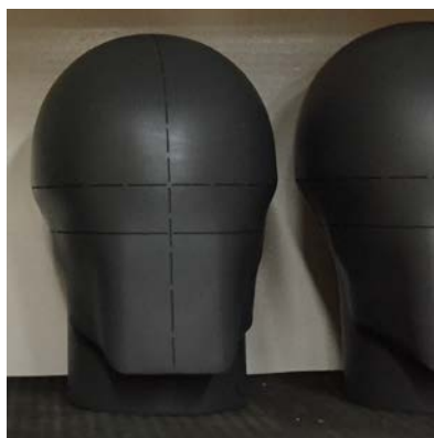
Figur 1. EN 960-provhuvud som används vid certifieringstestning
